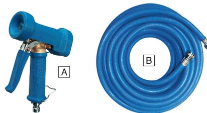
**A** Corps en laiton massif. Entièrement recouvert en caoutchouc alimentaire. Résiste à 80°C - 25 bar. Raccordement diam. 1/2 F. Equipé d'un embout de coupleur rapide.
